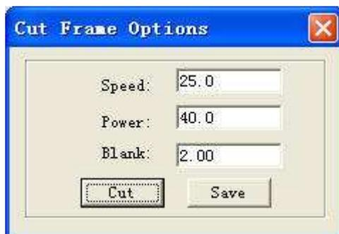
**Speed:** vous pouvez choisir différentes vitesses en fonction des matériaux différents. Il est préférable de confirmer la vitesse appropriée au moyen de tests.
