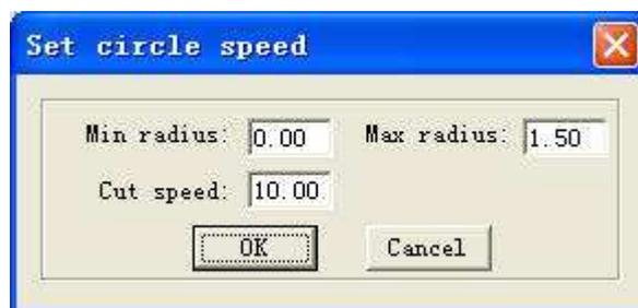
Lorsque le rayon du cercle est dans la gamme entre "Min radius" et "Max radius" , la vitesse de coupe sera automatiquement remplacé par le nombre de "Cut speed".
