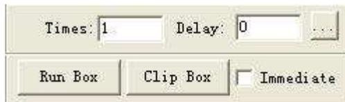
**Times and Delay:** Si l'entrée 10 de "Times" et 20 "Delay", puis appuyez sur "Run", vous pouvez obtenir 10 mêmes graphiques. Et il restera pendant 20 secondes après chaque traitement terminé. Les 20 secondes pour l'alimentation sont pour le démontage matériel. Un autre temps peut être réglée si vous avez besoin. Cette fonction peut augmenter l'efficacité d'un lot.
